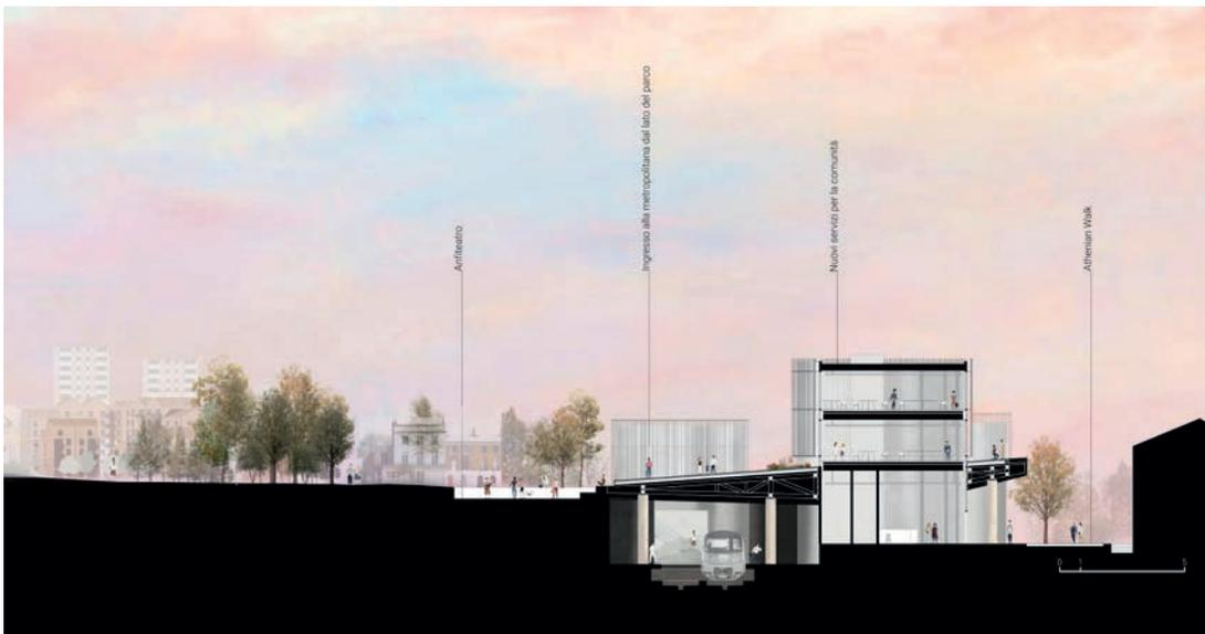
I volumi si incastrano nella copertura come sassi nel terreno creando spazi connessi su più livelli. Nella parte superiore sono stati schermati da una seconda pelle costituita da listelli in pietra che, pur proteggendo dalla luce solare diretta garantiscono la trasparenza e il contatto interno-esterno.
