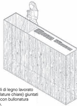
**b.** Volume in pannelli di legno lavorato (colore nero con velature chiare) giuntati a incastro e fissati con bullonatura al solaio in cemento.
